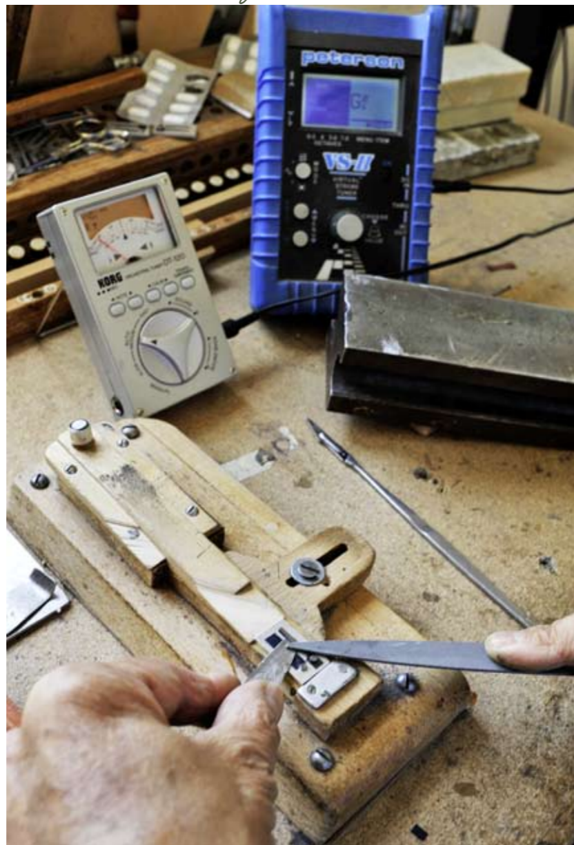
Die hohe Kunst des Stimmens. Mit einer Feile werden die Stimmzungen so geschliffen, dass der Ton höher oder tiefer schwingt.
